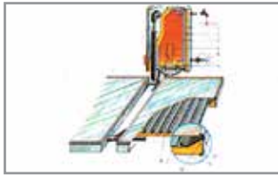
1976 Design of the vertical storage tank with open circuit system (100, 150 & 200 lt) • Σχεδιασμός συσκευής με κάθετη δεξαμενή ανοιχτού κυκλώματος (χωρητικότητα 100, 150 & 200 lt.)
