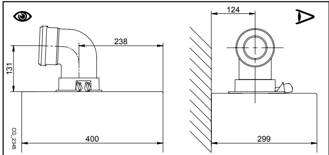
Στερεώστε τους σωλήνες απορρόφησης με δύο ψευδαργυρωμένες αυτοκοχλιούμενες βίδες Ø 4,2 mm και μέγιστου μήκους 19 mm. Άν οι βίδες δεν υπάρχουν στην προμήθεια, θα πρέπει να τις βρείτε στην αγορά με τα ίδια χαρακτηριστικά.
