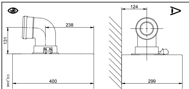
Fixați conductele de aspirație cu două șuruburi zincate autofiletante Ø 4,2 mm cu lungimea maximă de 19 mm. Dacă șuruburile nu sunt incluse în dotarea standard, folosiți șuruburi cu aceleași caracteristici, disponibile în comerț.
